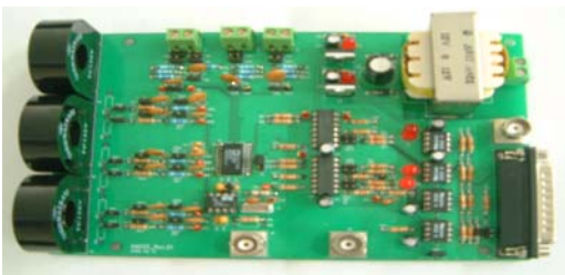
그림 6. 3상 데이터 처리부 시작품 Fig. 6 A prototype of a three-phase data processing part
