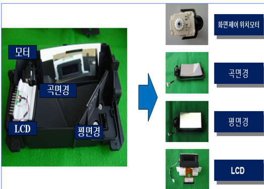
그림 5. 실제 제작한 통합스마트 모니터 시스템의 구성 Fig. 5 Developed intelligent integrated smart monitor system
