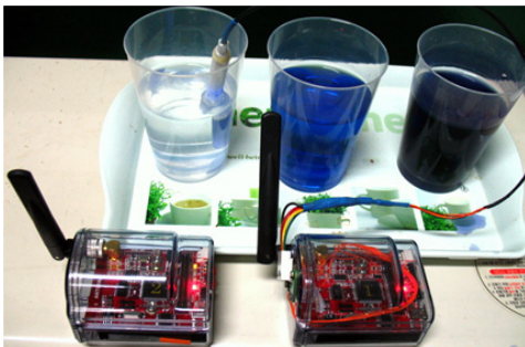
그림 6. 탁도를 센싱하는 Zigbee 노드 Fig. 6 Zigbee node sensing turbidity
