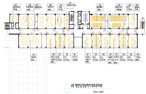
그림 1. 실제 도면을 이용한 로봇 지도 작성 Fig. 1 Robot Map Building Using Actual Drawing
