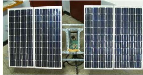
그림 6. 태양광 위치추적기 장치 모형사진
