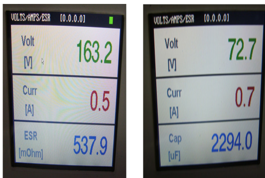
그림 10 커패시터 진단 시스템의 디스플레이 화면 Fig. 10 Display capture of capacitor diagnosis system.
