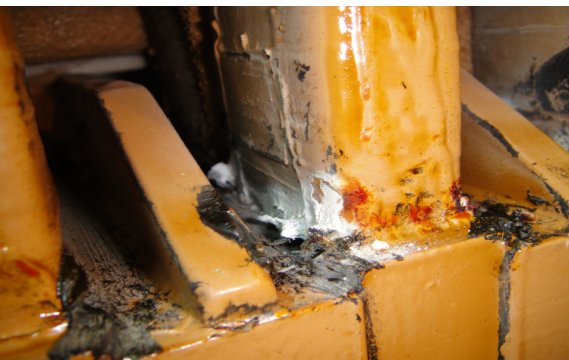
그림 2 슬롯인출 부위 백화현상 Fig. 2 White powder on endwinding from slot
