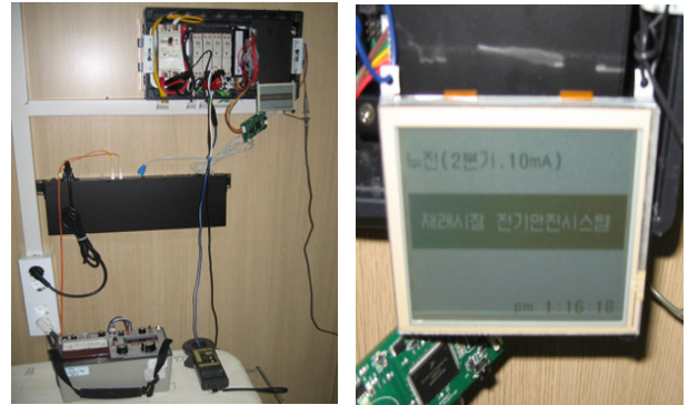
그림 7 누설전류 발생 및 LCD에 상태 표시 Fig. 7 Leakage generation and LCD warning display
