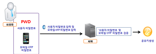
(그림 5) 비밀번호&OTP 값을 이용한 공유키(대칭키) 생성
