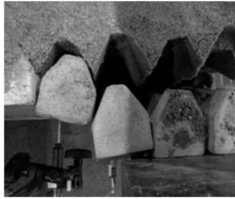
그림 18. 보강재를 설치하지 않은 경우 0.2g에서의 옹벽의 파괴
