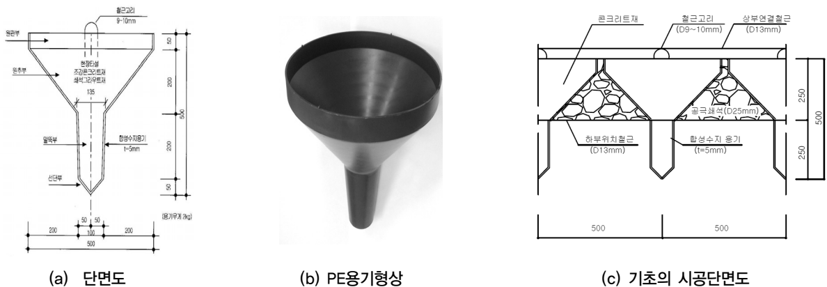
그림 1. 현장타설 팽이말뚝기초의 형상 및 시공단면도
