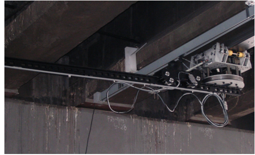
그림 5. 교량검사 시스템 Fig. 5. Bridge inspection system
