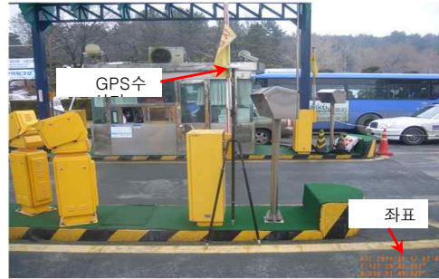
FIGURE 4. DGPS를 이용한 시설물 측량
