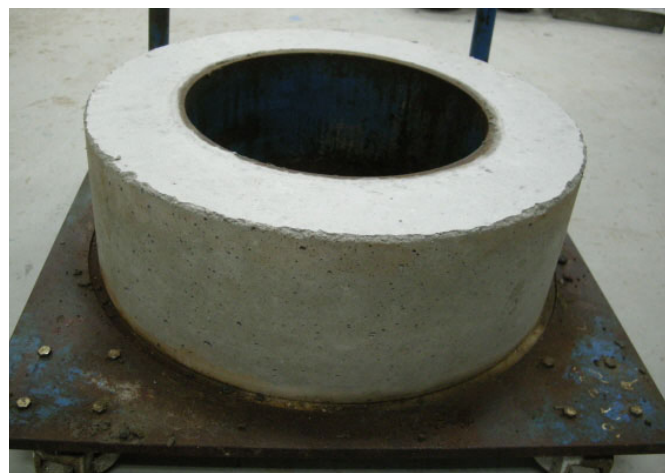
그림 3. O-Ring test 실험결과
