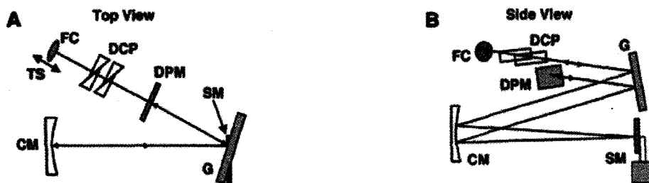
그림 8. 회절격자를 이용한 위상 변조기의 개략도 [18]. (A) 위에서 본 단면, (B) 옆에서 본 단면.
