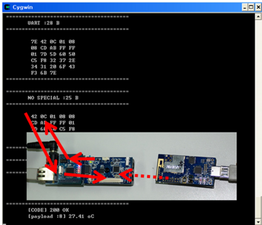
그림 15. 센서 노드 적용된 덤프 및 데이터 흐름 Fig. 15 Message Dump and Data Flow with Sensor Nodes
