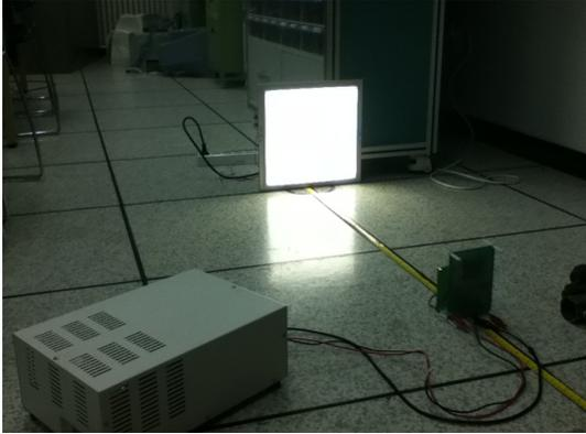
그림 4. LED 조명을 이용한 거리 측정
