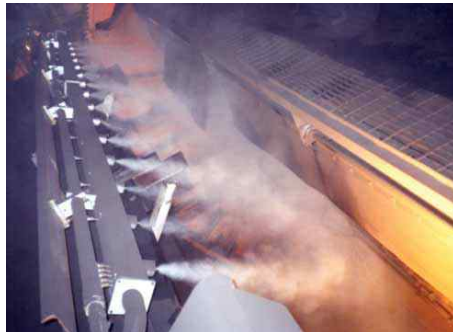
<그림 3> Dust Solution Inc사의 Dry Fog 분진억제시스템
