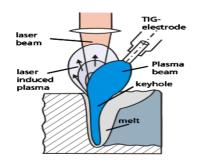
Fig. 1. Laser-GTA Hybrid Welding System.
