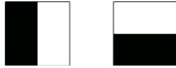
그림 5. x 와 y 방향의 Haar wavelet 필터 Fig. 5. Haar wavelet filters in x and y directions
