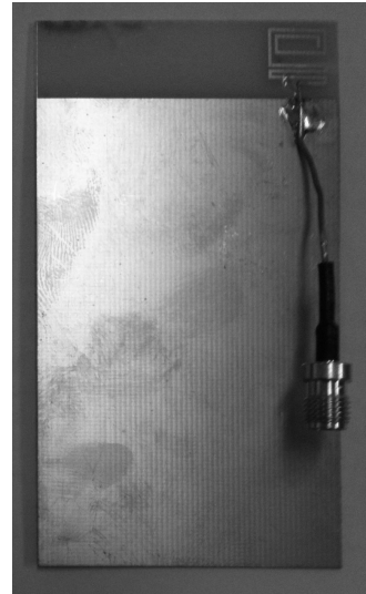
그림 7. 제작된 안테나 Fig. 7. Photograph of fabricated antenna.
