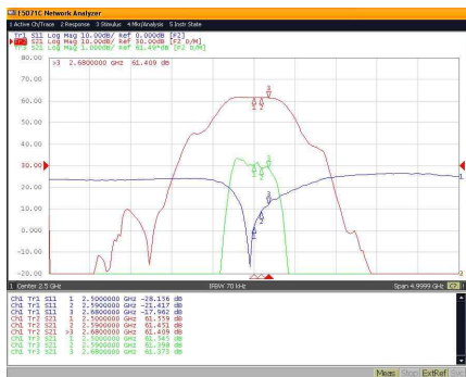
[그림 8] 팔렛트 타입의 60watt급 도허티 증폭기 모듈의 측정된 S-파라미터
