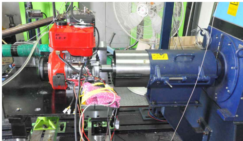
[그림 4] EFI 소형엔진의 다이내모미터 장착사진
