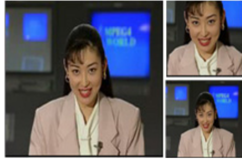
그림 8. 시험영상 Akiyo에 대한 재설정 결과: (좌) 원 영상 프레임, (우상) 제안한 기법에 의해 절반 크기로 재설정된 결과, (우하) 일반적인 재설정 결과. Fig. 8. Retargeted results for test video Akiyo: (Left) Original frame, (Right-top) The half-size retargeted frame achieved by proposed method, (Right-bottom) Conventional method.
