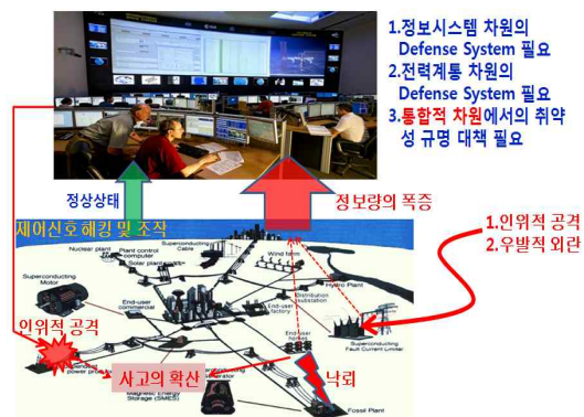
그림 3. 전력계통과 SCADA 시스템 간의 상호작용 Fig. 3. Interactions btw Different Layers
