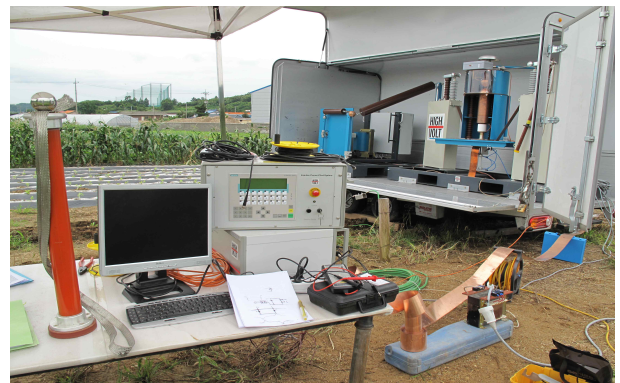
그림 7. 과도접지임피던스 측정시스템 외관 사진 Fig. 7. Outside view of the transient grounding impedance measuring system
