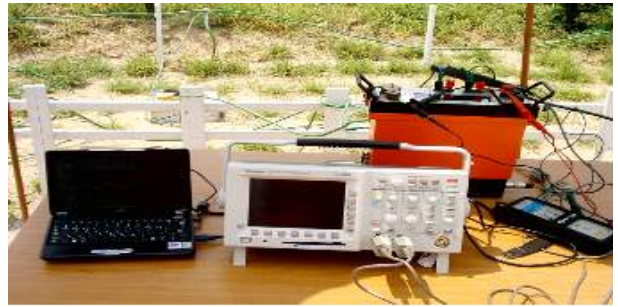
그림 5. 접지저항 측정시스템의 외관사진 Fig. 5. Outside view of the grounding resistance measuring system
