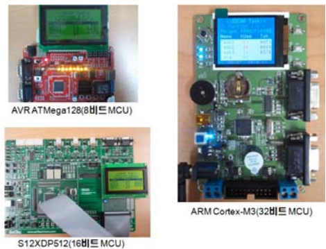
그림 12. OSCAR-OSEK 지원 MCU Fig. 12. Support MCUs of OSCAR-OSEK
