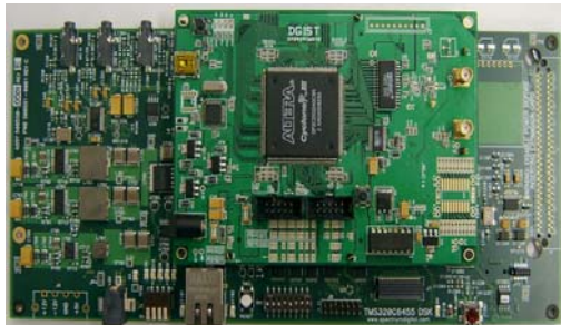
그림 4. FMCW 레이더 신호처리 모듈 보드 실물 Fig. 4. Designed board of signal processing module for FMCW Radar
