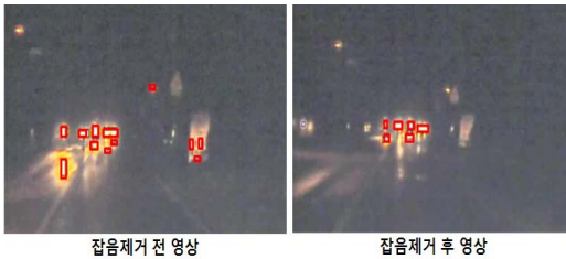
그림 8. 형태학 필터를 통한 도로 반사체 제거 결과 Fig. 8. Result images through shape filter
