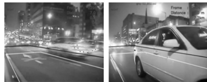
그림 2. 영상 관심 영역 및 근접 영역 Fig. 2. Region of interest (black line) and region of proximity (white line)
