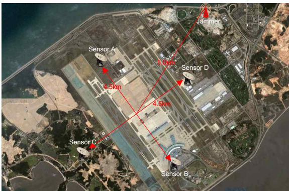
그림 4. 4개의 센서 및 전파위협원 배치 Fig. 4. The 4 sensors and position of jammer
