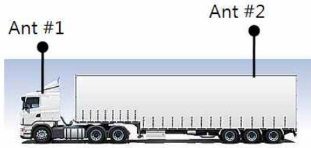
그림 4. 굴절형 차량과 GPS 안테나 배치 Fig 4. Articulated vehicle and GPS antenna configuration
