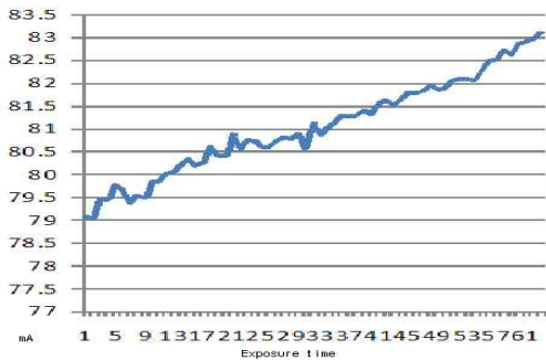
그림 3.4 촬영 횟수증가에 따른 관전류의 변화 80 [mA] Fig. 3.4 [mA] value depend on exposure times at the 80 [mA]
