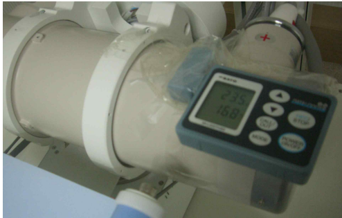
그림 3.1 X-ray 튜브에 온도계 부착 Fig. 3.1 Attached temperature on the x-ray tube
