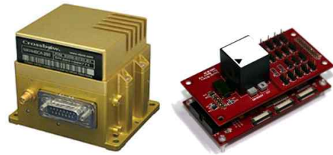
그림 1. 상용 항법장치와 자체 개발된 AHRS Fig. 1. COTS navigation system and the self-developed AHRS
