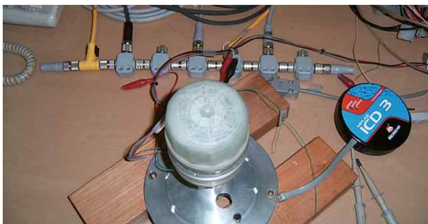
그림 10. NMEA 2000 네트워크 실험 장치의 결선 Fig. 10. NMEA 2000 Network connection of the experimental device
