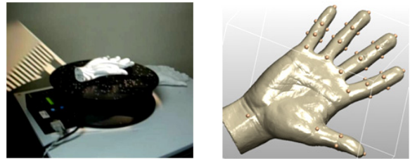
(a) 손 석고본의 3D scanning 모습 (b) 측정 참조점이 표기된 3D digital hand
