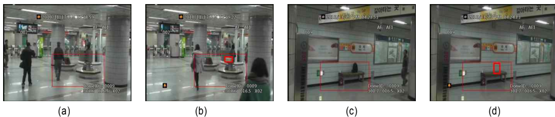
그림 6. DSP 기반의 방치 및 제거된 객체 검출의 실험결과 (a)방치이벤트 배경영상, (b)방치이벤트 현재영상, (c)제거이벤트 배경영상, (d)제거이벤트 현재영상 Fig.6 A Result of DSP-based of Abandoned and Removal Object Detection (a) Background Image of Abandon Event, (b) Current Image of Abandon Event (c) Background Image of Removal Event, (d) Current Image of Removal Event
