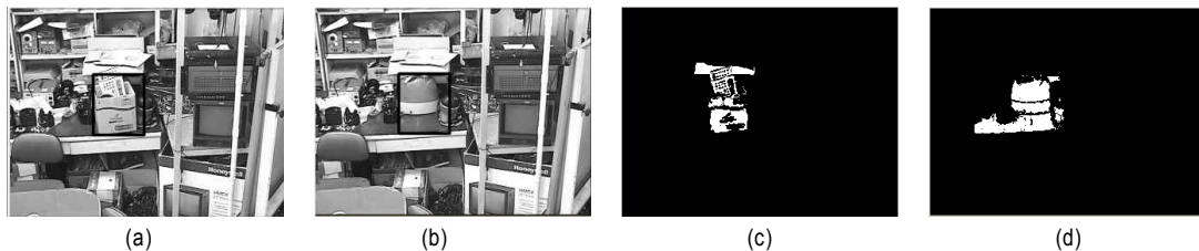
그림 7. 영역 성장법을 이용한 제거된 객체 검출결과 : (a)배경영상, (b)현재영상, (c)배경영상(영역성장 후) (d)현재영상(영역성장 후) Fig. 7. A Result of Removed Object Detection by Region Growing Method (a)Background Image, (b)Current Image, (c)Background Image(after Region Growing method) (d)Current Image(after Region Growing method)
