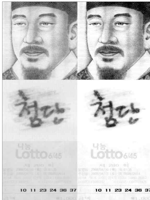
그림 21. 그레이 스케일 타겟의 값을 적용한 결과 (좌 : 적용 전, 우 : 적용 후)
