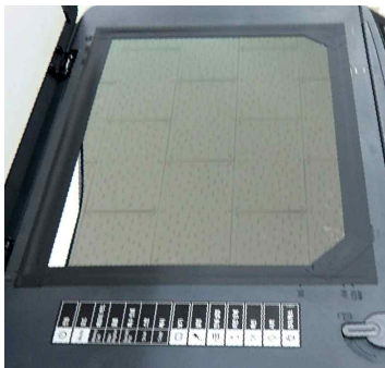
그림 12. 적외선 투과 필터의 장착
