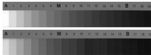
그림 18. 가시광선과 적외선 평판 스캐너로 스캔한 그레이 스케일 (위 : 가시광선, 아래 : 적외선)
