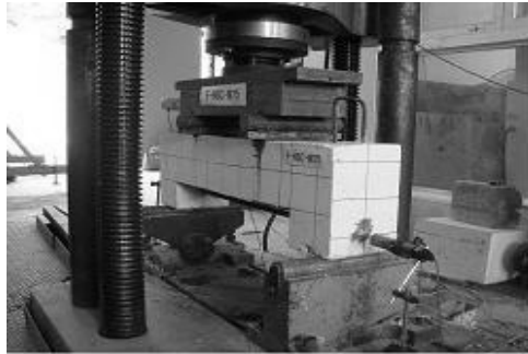
사진 1. 실험체 설치(Seting) 전경
