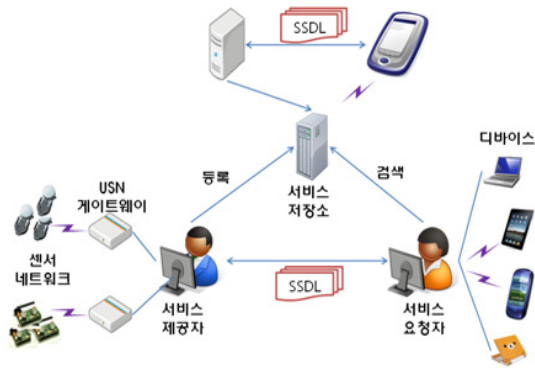
그림 2. USN 응용 서비스를 위한 참조모델 구조 Fig. 2 Reference Model Structure for USN Application Service
