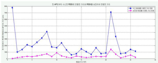
그림 4. 환경데이터베이스를 이용하여 보정한 RSSI를 이용한 거리 변환 결과 Fig. 4 Distance transform result of modified RSSI using environment database
