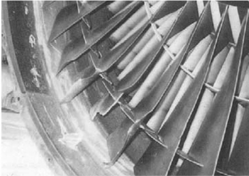
〈그림 1〉 조류충돌에 의한 엔진 브레이드 파손
