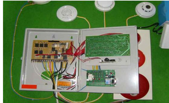
그림 8 기존의 자동화재탐지설비에 내장한 제안한 방재용 자동화시스템 구성도
