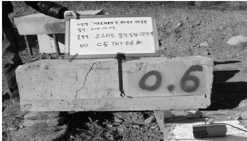
그림 2. 콘크리트블록 발파실험 전, 후(Test No. C-05)
