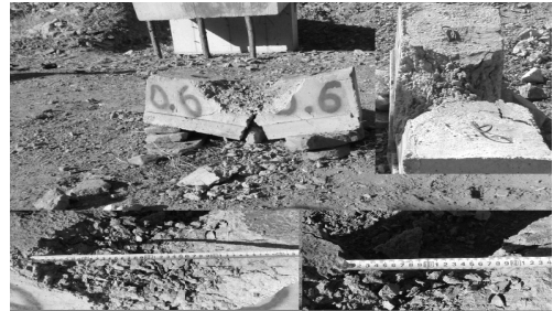
그림 2. 콘크리트블록 발파실험 전, 후(Test No. C-05)
