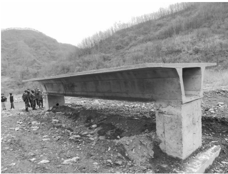
그림 5. 콘크리트 박스거더 교량모형 실험 전, 후
