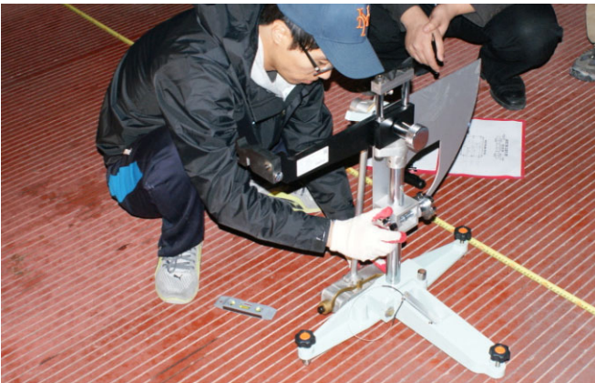
그림 15. 프리캐스트 슬래브 미끄럼저항 측정
