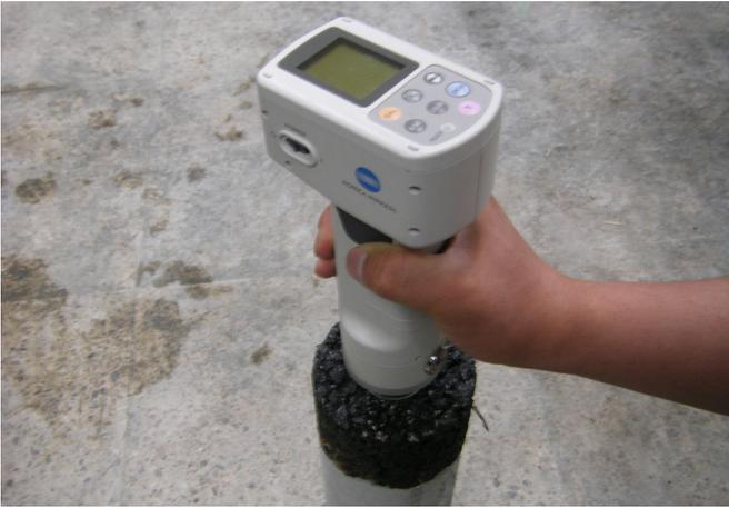
그림 5. 색차시험 전경
