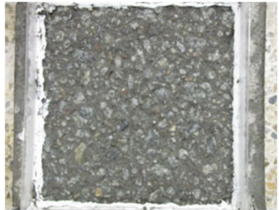
그림 3. 롤러 전압 콘크리트 포장의 스케일링 시험 결과(이승우, 2010)
