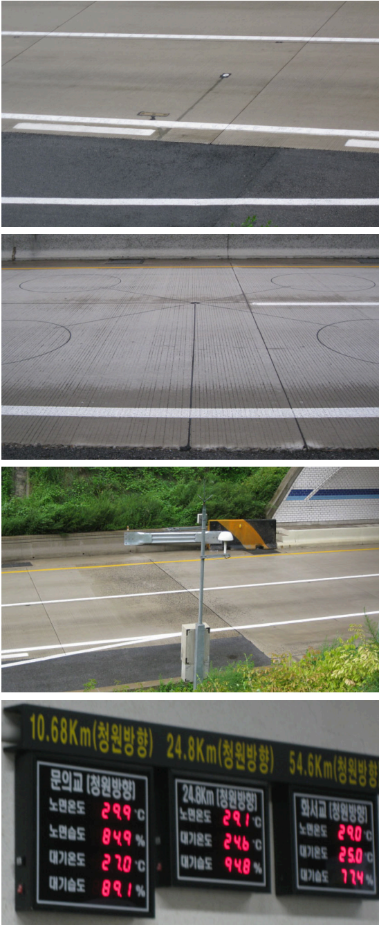
그림 7. 연구지점의 접촉식 노면온도측정 센서, 도로변 기상관측장비, 센터 전경
