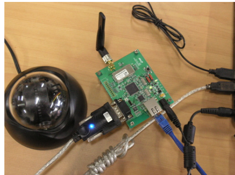
그림 6. 개발 RF통신모듈 보드의 성능시험
