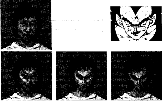
그림 3: \alpha 값에 따른 와핑 결과 이미지. (위 왼쪽)대상 이미지와 특징점, (위 오른쪽)참조 이미지와 특징 모델, (아래) \alpha 값에 따른 와핑 결과 이미지
